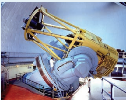
Das 250t schwere 3,5m-Teleskop von European Southern Observatory in La Silla/Chile wird gesteuert von 4 Linearverstärkern DCP2000/60C
