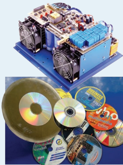
Technotrans-150A Prozessstromquelle zum Galvanisieren von CD-Matrizen aus Rein-Nickel
