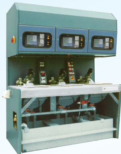
Galvanikbäder mit Prozeßsteuerung und Überwachung
