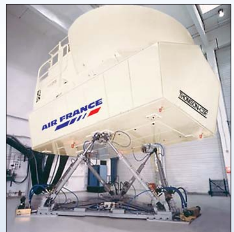
DCP520/60 übernimmt die Pilot-Horizont- steuerung in einem Thomson-Flugsimulator
