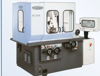
Verzahnungswälzschleifmaschine RZ300E DCP 520/60-C in der Zustellachse Reishauer , Wallisellen-Zürich
