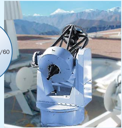
C.E.L.T.- Projekt in Kalifornien 35cm Cassegrain-Teleskop von Halfmann Teleskoptechnik.
