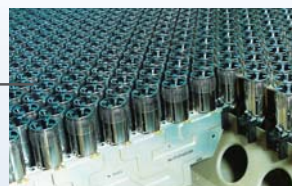
Strahleranordnung mit Leistungsverteilern
