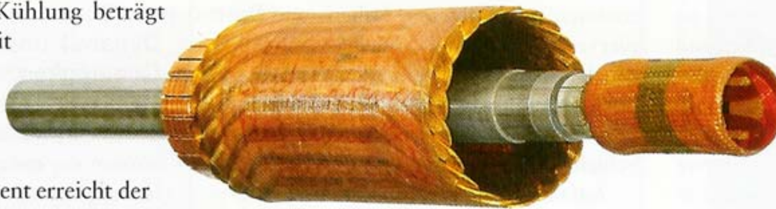
2 Glockenankermotor mit selbsttragender Rotorspule aus Kupferdraht, Glasfaser und Epoxydharz: Der Luftspalt zwischen Rotor und Stator beträgt nur 0,25 \text{ mm} , die massive Verbindung zwischen Antriebsspule und Tachospule stellt eine sehr steife Kopplung dar
